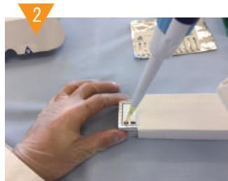
付属のピンセットでA槽のアルミカバーを開け検体を入れる。数回ピッティングして混和する。
