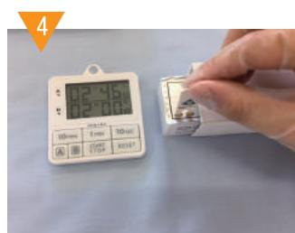
開封したA槽にコームカードを差し込み、5分間浸漬する。途中上下に数回小刻みに動かす。
